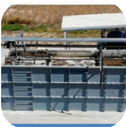
Système MBR réacteur biologique + filtration par membrane
