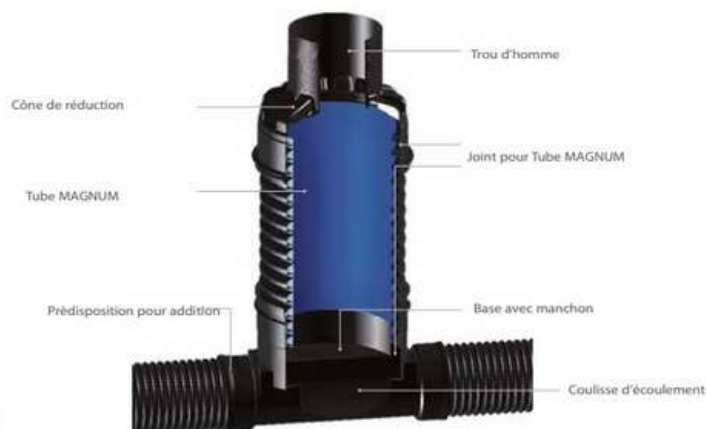
Regard PE PE Inspection chamber
